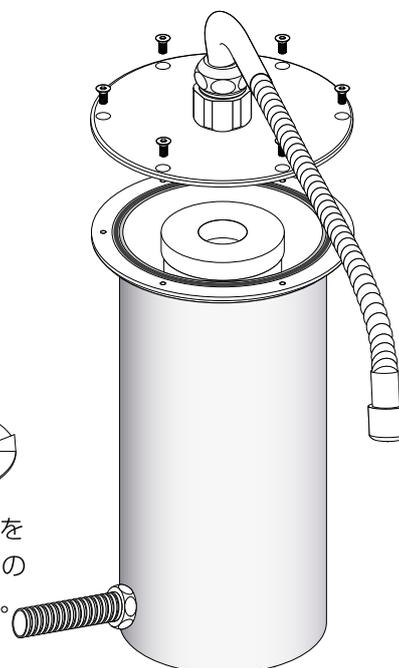
**12** 「本体フタ」を閉じます。6本の六角穴付ネジを六角レンチで時計回りに回して締めて下さい。六角穴付ネジは6本が均等な力で締まるように調整しながら締めてください。
